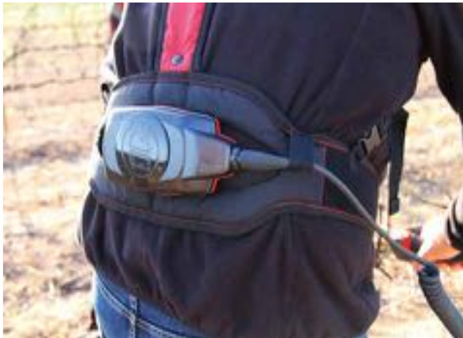
Ultracompacte, la batterie 831B d'Infaco a une capacité de 120 Wh, soit environ 8 h de travail avec un sécateur.
