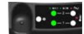
7. De twee batterijen zijn opgeladen: - Vak 1 : Vaste groene led. - Vak 2 : Vaste groene led.
