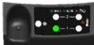
2. Wanneer de batterij geplaatst is, detecteert de lader de batterij en begint het opladen: - Vak 1 : Snel knipperende groene led tijdens de hele laadtijd
