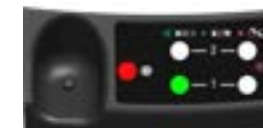
3. Overwinteringsproces beëindigd: - Het overwinteringsled blijft constant rood branden. Led vak 1 (en vak 2 indien 2 batterijen) blijft constant groen branden. De batterij moet uit de lader worden gehaald en in koffer worden bewaard.
