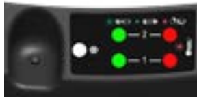
3. Bij het onder spanning zetten treedt de lader in werking: groene led + rode led branden gedurende 2 seconden.
