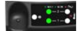
7. 배터리 두 개가 충전 되었습니다. - 1번칸 : 녹색 LED가 깜박이지 않습니다. - 2번칸 : 녹색 LED가 깜박이지 않습니다.
