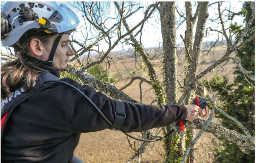
Le nouveau système de portage de la batterie utilise un câble droit intégré et un brassard rapide passe-câble.
