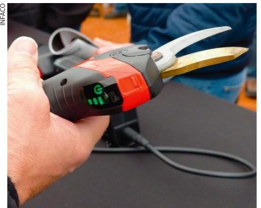
Les informations de fonctionnement du sécateur, telles que le dispositif de sécurité DSES et l'activation du mode Soft, sont visibles sur l'écran de contrôle.
