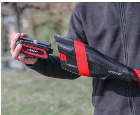
La batterie se clipse dans le corps de la perche fixe ou télescopique pour le travail en hauteur (des versions à câble sont également disponibles).
