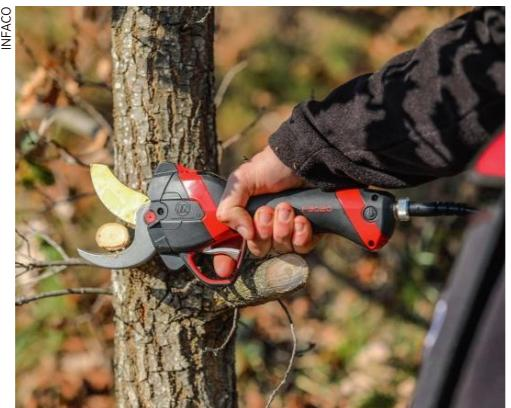
Le corps de l'appareil est en aluminium. Les réglages de la demi-ouverture et du croisement de lame sont électroniques.
