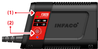
3. Όταν ο φορτιστής ρευματοδοτηθεί, ενεργοποιείται. Η λυχνία LED κατάστασης (1) εναλλάσσει κόκκινο/πράσινο και η λυχνία LED αδράνειας (2) ανάβει για 3 δευτερόλεπτα
