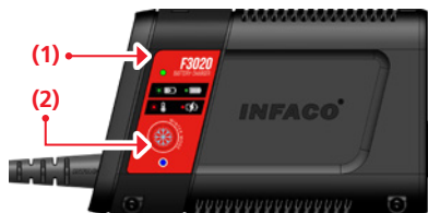
3. Amint feszültség alá kerül, a töltő inicializálódik. Az állapotjelző LED (1) felváltva piros és zöld és a téli tárolás LED (2) 3 másodpercre felgyullad
