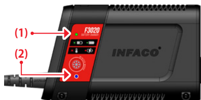
3.電源が入ると、充電器は初期化します。ステータスLED(1)が赤／緑に交互に点灯し、越冬 LED (2) が3秒間点灯します
