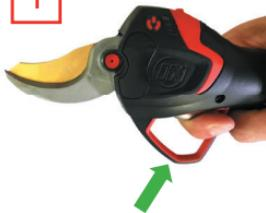
전정 가위를 전원에 연결하여 켠 후, 칼날이 들어가 있는지 확인한 다음 방아쇠를 누르고 있으면, 막대 그래프에 불이 들어오고, LED 상태 꺼짐/켜짐 버튼이 적색이 됩니다.
