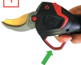
Po podłączeniu i włączeniu sekatora upewnić się, że ostrze jest zamknięte, a następnie nacisnąć i przytrzymać język spustowy, pasek LED zgaśnie, a dioda LED stanu ON/OFF zmieni kolor na czerwony.
