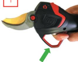
Na het aansluiten en inschakelen van uw snoeischaar, dient u ervoor te zorgen dat het mes is gesloten. Trek vervolgens aan de trekker zonder deze los te laten, de staafaanwijding schakelt uit en de ON/OFF-statusled wordt rood.
