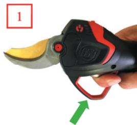
剪定ばさみを接続し、スイッチを入れた後、刃が閉じているかを確認し、トリガーを握った状態で引き続けます。バーグラフは消えてLEDステータスのオン/オフが赤になります。
