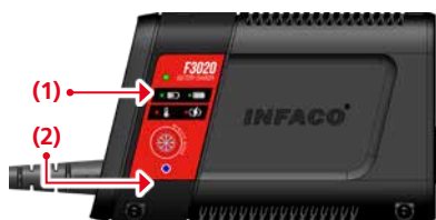
3. Při zapnutí se nabíječka inicializuje. Stavová LED (1) střídavě bliká červeně/zeleně a LED zazimování (2) svítí po dobu 3 vteřin
