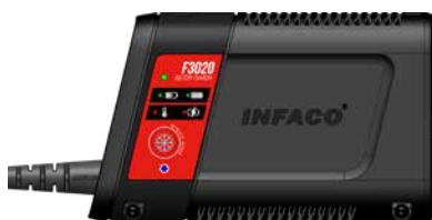
4. Jakmile LED diody přestanou svítit, nabíječka je připravena k provozu.
