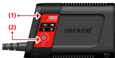
3. De lader start zodra die is aangesloten op het net. De status-led (1) wisselt rood/groen af en de led voor overwintering (2) brandt gedurende 3 seconden
