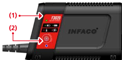
3. Laderen klargjøres når den slås på. Statuslampen (1) veksler mellom rødt og grønt, og dvalelampen (2) lyser i 3 sekunder
