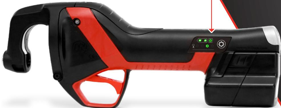
Mit dem AT1000 stehen Ihnen Verdrillungsstufen von 1 bis 4 zur Verfügung. Die Einstellungen sind direkt auf dem Anzeigebildschirm der Maschine ablesbar.
