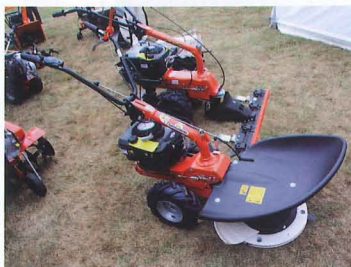
La cellule multifonction P55 (moteur Honda de 160 cm 3 ) avec faucheuse à disque (ci-contre) et le motobalai d'Eurosystems (ci-dessus).
