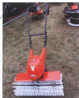
La cellule multifonction P55 (moteur Honda de 160 cm 3 ) avec faucheuse à disque (ci-contre) et le motobalai d'Eurosystems (ci-dessus).
